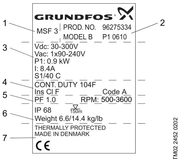
Fig. 3. Nameplate, motor
